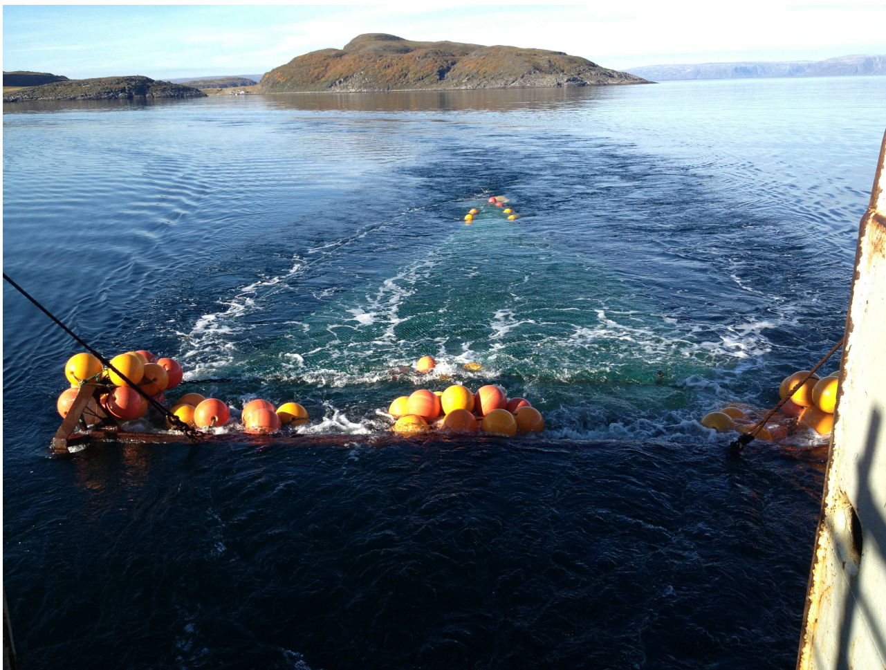
Figur 6. Agassiz-trål med fløyt og sekk.
