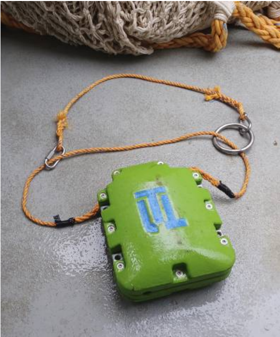
Bilde 7. Festemåter for mekanisk utløser.
