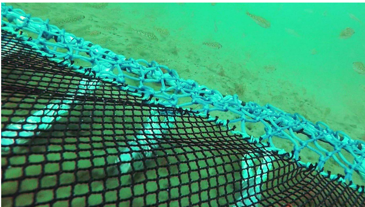
Bilde 8: Nedre del av snurrevaden som trekkes over sandbunn. Fisk som svømmer foran nota kan skimtes øverst til høyre.
