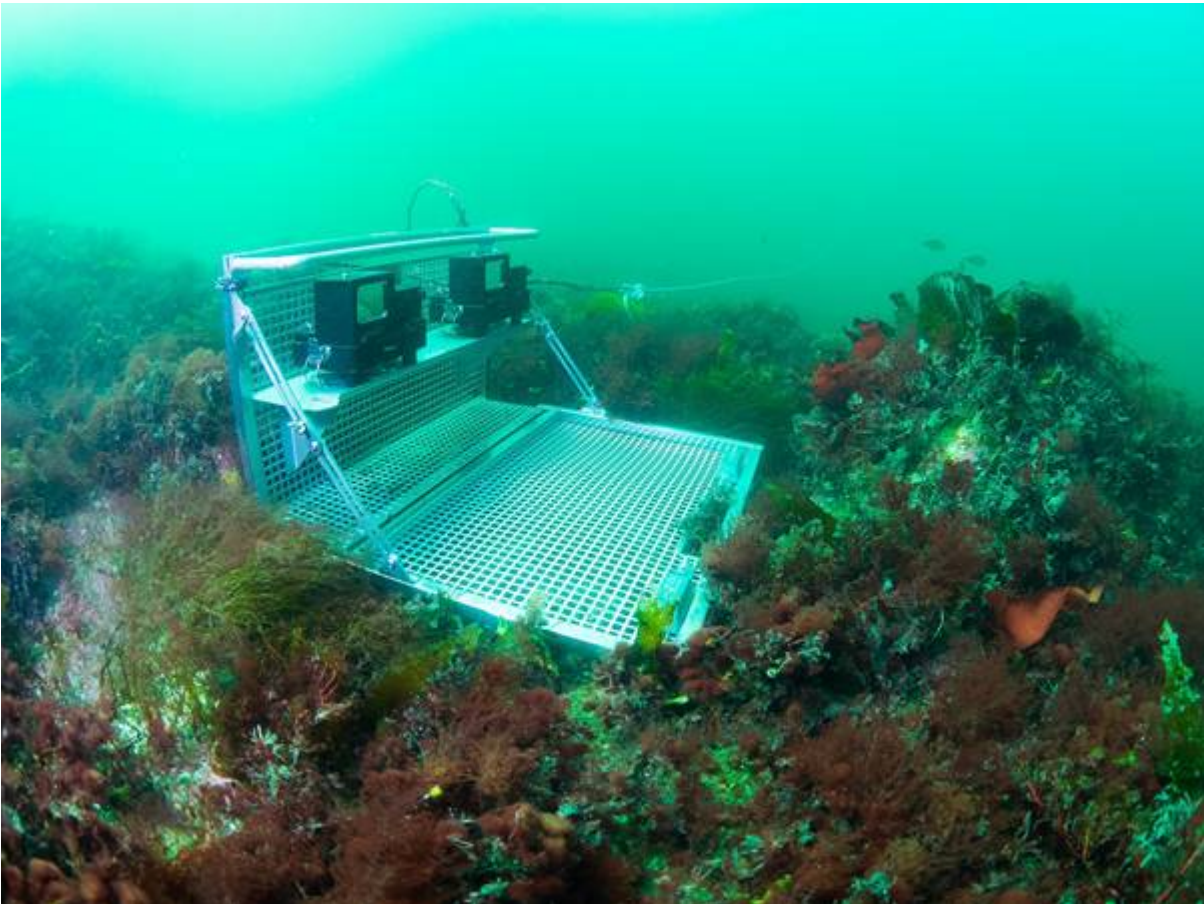
Bilde 4: En uagnet undervanns stereo-videorigg (RUV), der to kameraer vil filme samme område. Bilde tatt fra en drone. Video gir ingen skader på fisk som observeres.
