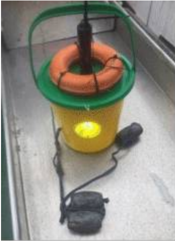
Montering av gul lysfelle (over til venstre). Oppsett for setting av lysfeller (over til høyre)
