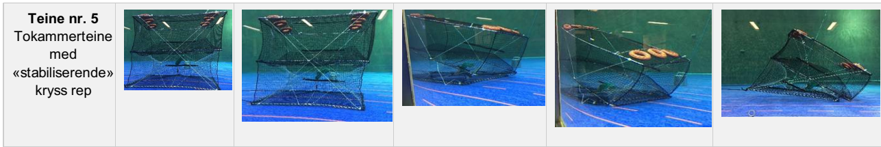
Figur 4. Bilder og beskrivelse av de 5 ulike riggingene av tokammerteinen som ble testet ut i strømtanken under økende strømforhold fra 0 to 1 knop.
