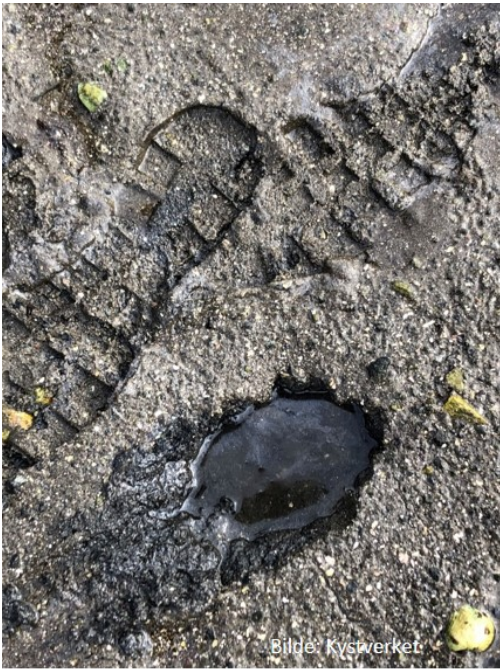
Figur 5. Bilde fra Kystverkets befaring i Nordre Sandvika 20. mars 2019. Bildet viser tråkk hvor olje piper opp.
