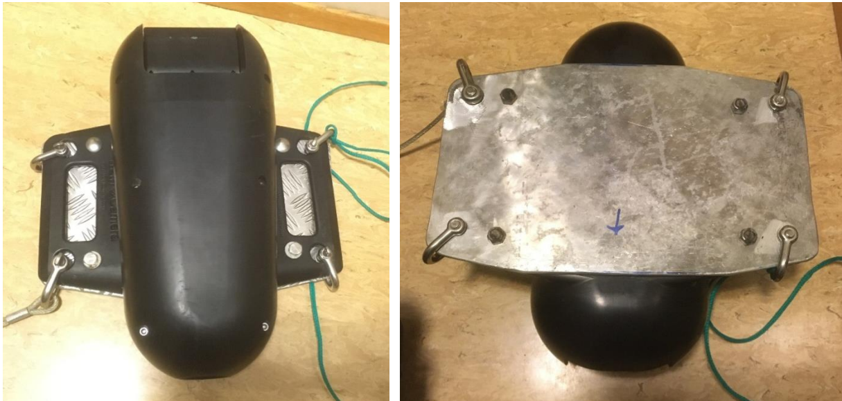
Figur A2. JT Electric TrawlCamera (venstre), med en forsterkningsplate montert av ingeniørene på «Vikingbank» under toktet (høyre).
