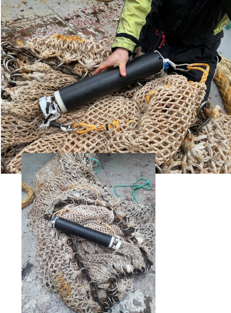
Figur 23. Rinko oksygenmåler, i beskyttende hus, festes innenfor skjørtet på trålsekken før den blir koblet til fiskepumpen under trålhal 03.
