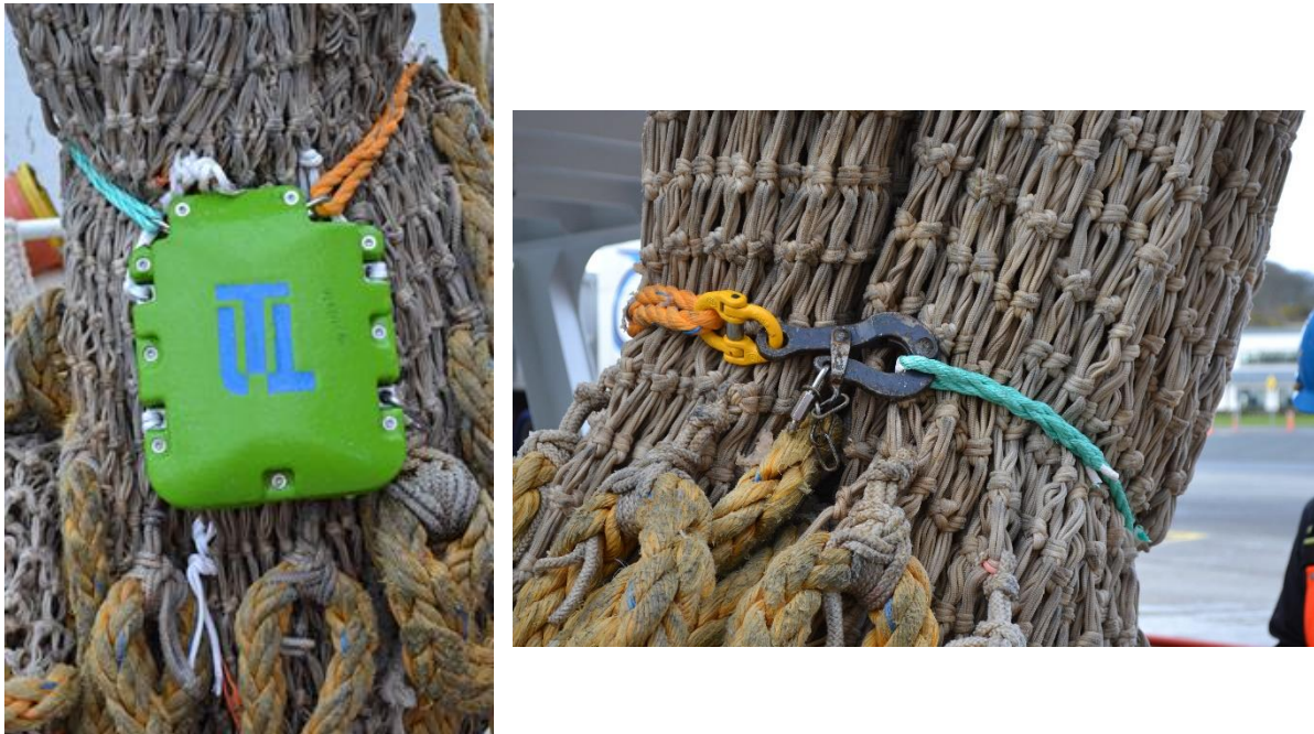
Figur 13: Fosstechs prototype av en sekkeutløser. Venstre: sekkeutløser montert på trålsekken. Høyre: utløsertau og fester.
