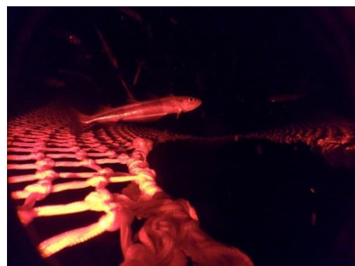
Figur 7. Trålhal 07 (rigg 3). Venstre: utenfor øvre utslippsåpning. Høyre: innenfor nedre utslippsåpning. Øverste linje: 00:39 – innhiving begynner, det er lav fisketetthet i fangstkontrollsystemet, åpningene er stengt, og lite fisk rømmer. Midterste linje: 00:48 – sensor #4 aktiveres, tettheten øker, åpningene blir bredere, og rømming via overpanelet øker. Nederste linje: 01:04 – 16 min etter at sensor #4 ble aktivert. Åpningene er nesten helt runde; mye rømming via overpanelet, lite rømming via bunnpanelet.
