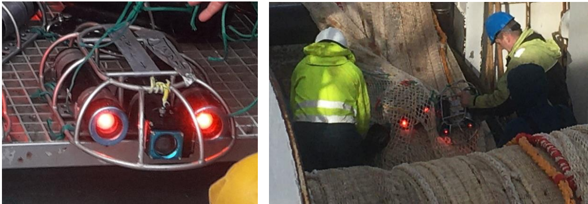
Figur A1. Stål-kameraramm» med kamera (i et Group B beskyttelseshus). Med to røde lys (venstre) og når den monteres/tas av trålen (høyre).
