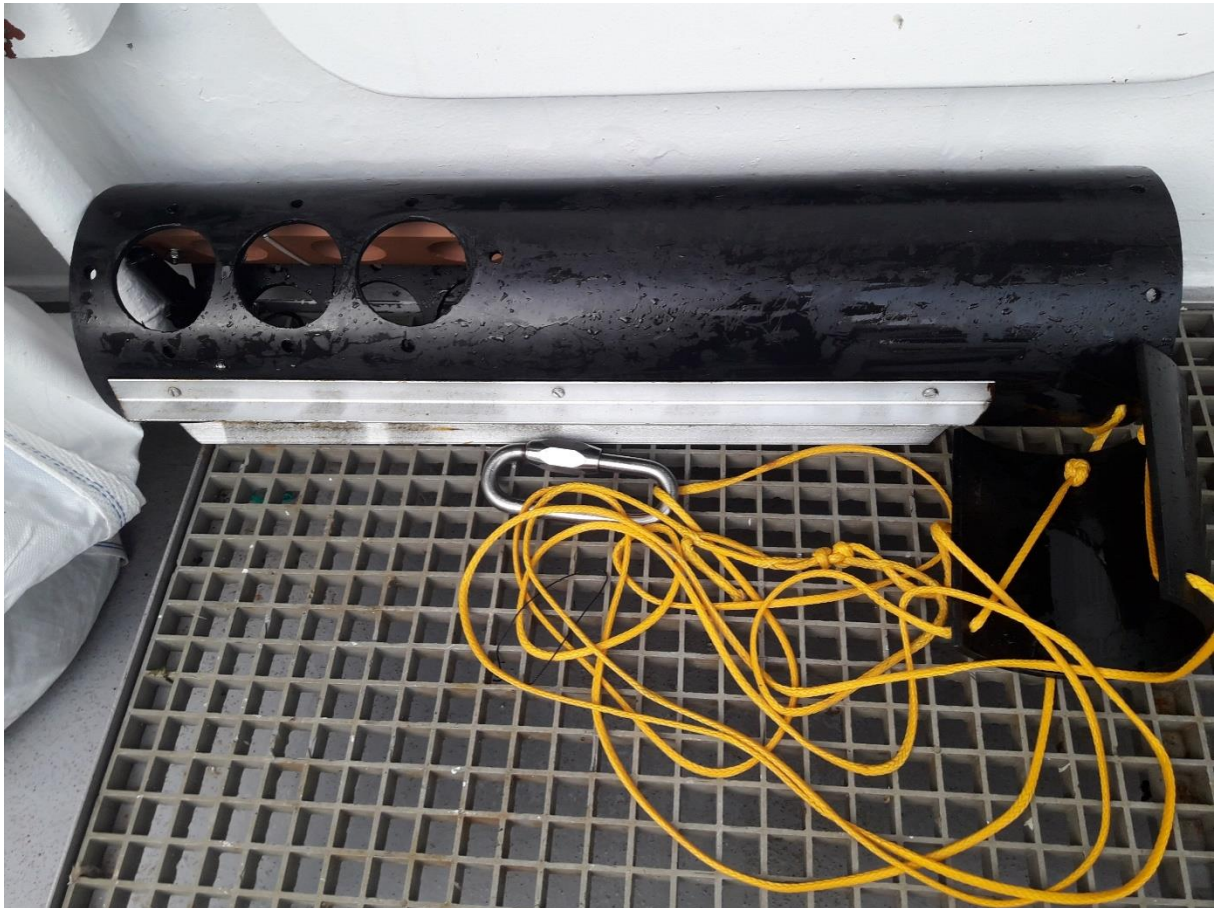
Figur A3. Beskyttelsehuset for «det flyvende kameraet» festet til kite med tau (Dyneema). [Kilde: J. Saltskår]
