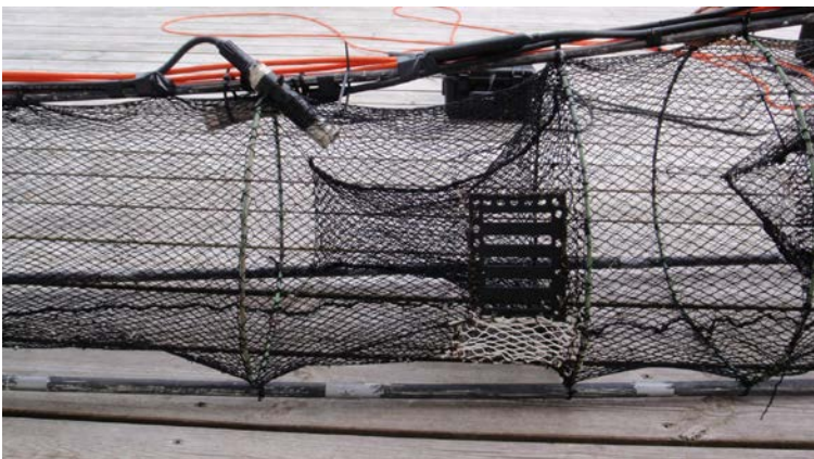
Bilde 5: Ruse med kamera for observasjon av utgang. Det er sydd inn hvit og svart grovmasket not samt plast rist. Dette for å se hvilke av de ulike alternativene leppefisken finner først og velger å gå på ut av.
