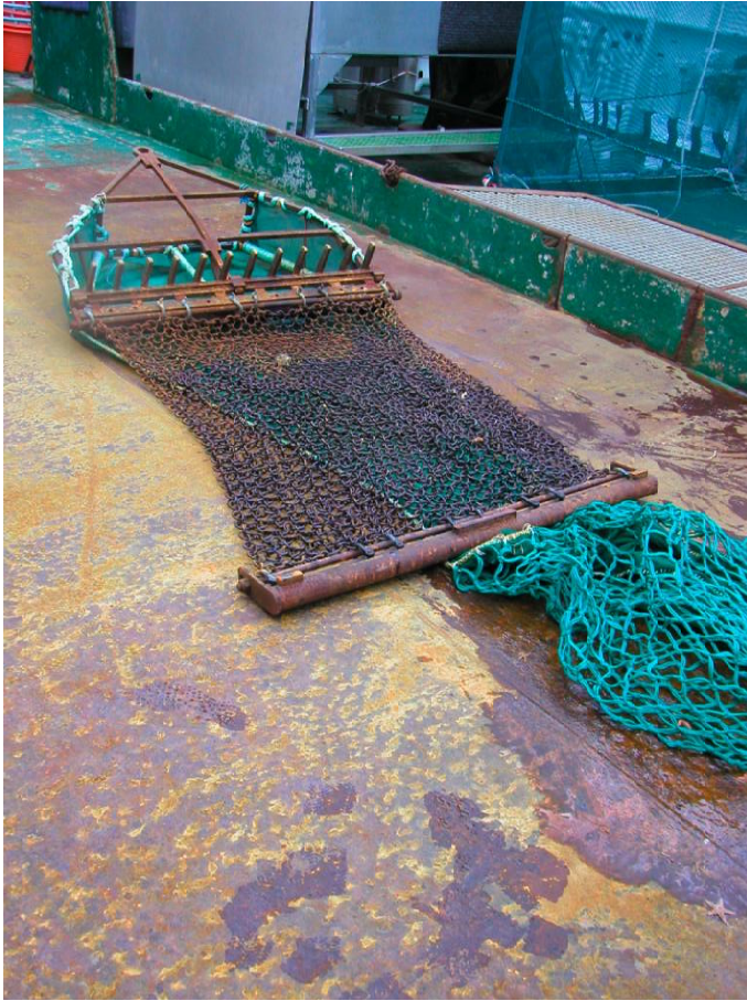
Figur 11b. Foto av Muslingskrape fra underside med ringbrynje. Standard oppsett bruker 10 mm vaier med en lengde som er 3 ganger bunn dyp pluss 50 m. Slepefarten er 2 knop og tauetiden er 10 minutter fra stopp slakk til start hiv.
