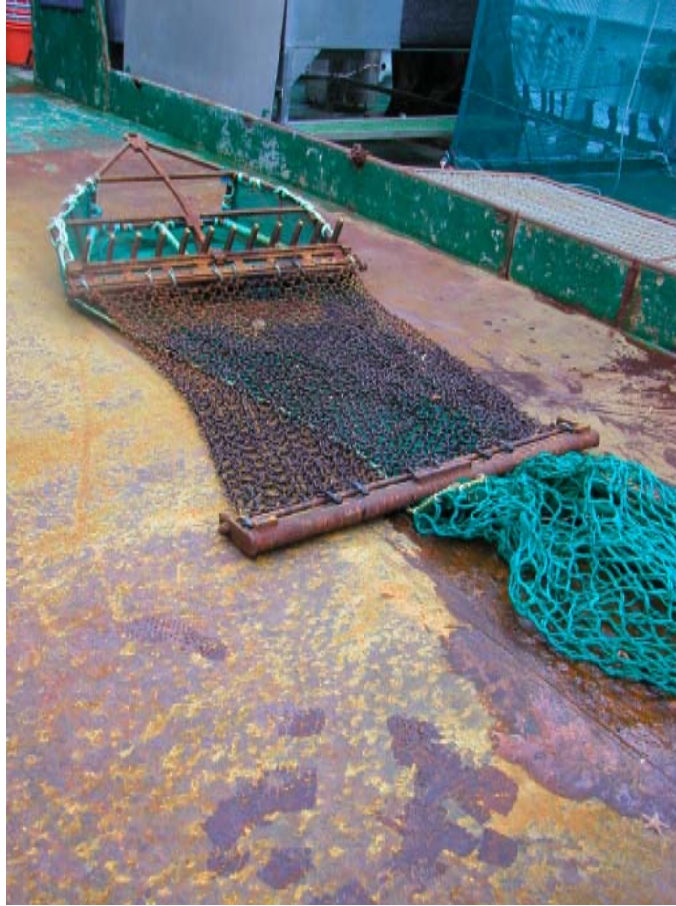
Fig. 5. Muslingskrape fra underside med ringbrynje. Standard oppsett bruker 10 mm vaier med en lengde som er 3 ganger bunndyp pluss 50 m. Slepefarten er 2 knop og tauetiden er 10 minutter fra stopp slakk til start hiv.
