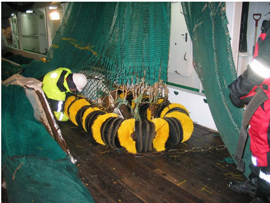
Figur 4 Campelen 1800 med børster mellom rockhopper skiver i midtgear
