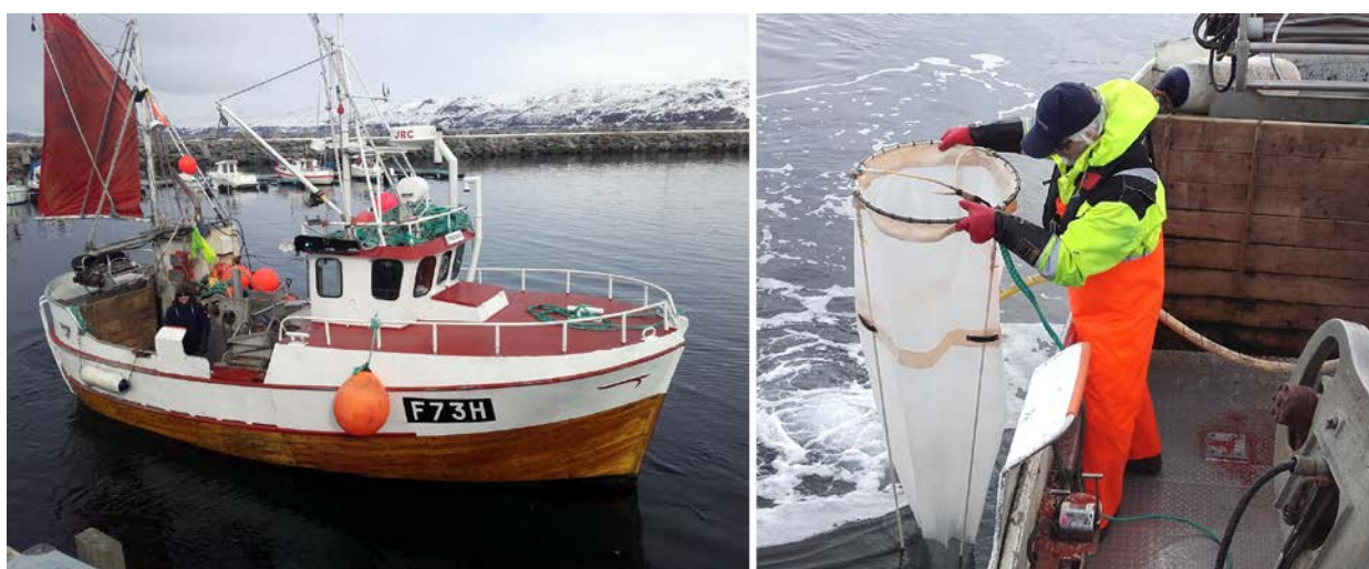
Figur 1. Båten som ble benyttet på de tre første toktene (t.v.) var en Finnvik 35' sjark med Petterspill og Rapphydemer etterhaler som ble benyttet til å dra egghåven (t.h.).
