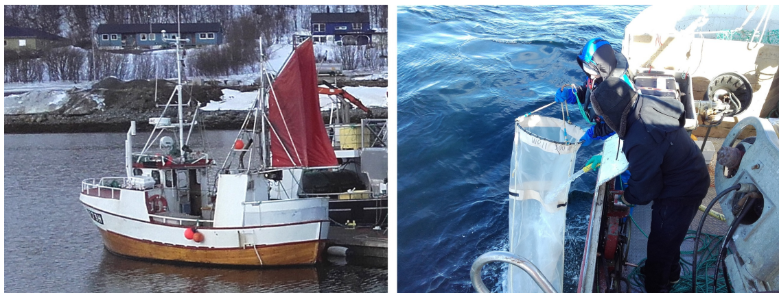
Figur 1. Båten som ble benyttet på de tre første toktene (t.v.) var en Finnvik 35' sjark med petterspill og raphydema etterhaler som ble benyttet til å dra egghåven (t.h.).
