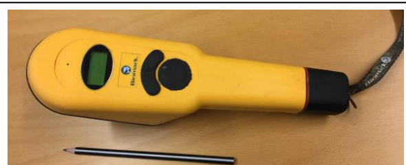
FIGUR 9. PIT-LESEREN SOM BLE BRUKT I MERKEFORSØK
