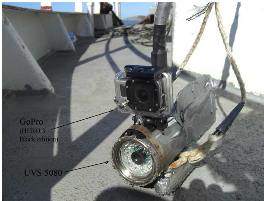
Figur 2. Undervannskamera benyttet til videoundersøkelser i Nordland.
