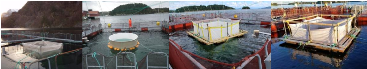
Figur 3. Bilder av prototyper av snorkelmerd. Tidsmessig utvikling fra venstre mot høyre. Design: Egersund Net.
