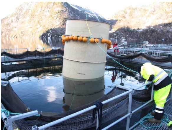
Figur 10. Bilde av snorkel benyttet i forsøket. Figur til høyre: Miljø (temperatur, saltholdighet og oksygen) gjennom forsøket.
