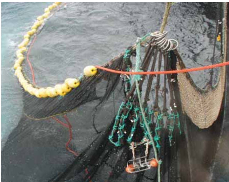
Figur 10. Omarbeidet brystparti, lange haneføtter. Notlin i brystpartiet henger langt unna ringene.
