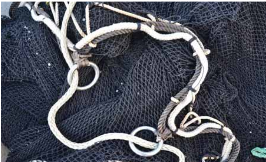
Figur 7. Forsøk notbryst ”Hillersøy”. Ringer direkte på fellingsstau og blytau (hvitt) montert langs fellingsstau. Hvitt geiltau tredd gjennom ringene nær notlin i brystet.
