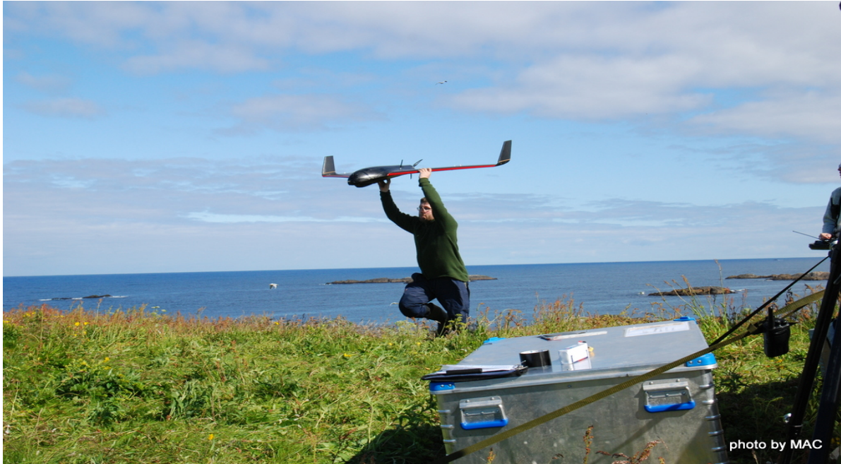
Figur 3. Dronen håndsendes opp mot vinden – så snart oppsenderen slipper taket, startes motoren og flyet sendes opp i ønsket høyde. Foto: Mario Acquarone
