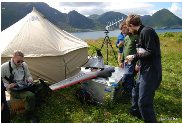
Figur 2. Dronen klargjøres til testflyging foran teltet som fungerte som kontrolltårn. ”Piloten” (til venstre) gjør klart konsoll for bakkebasert oppsending og landing av dronen. Foto: Mario Acquarone
