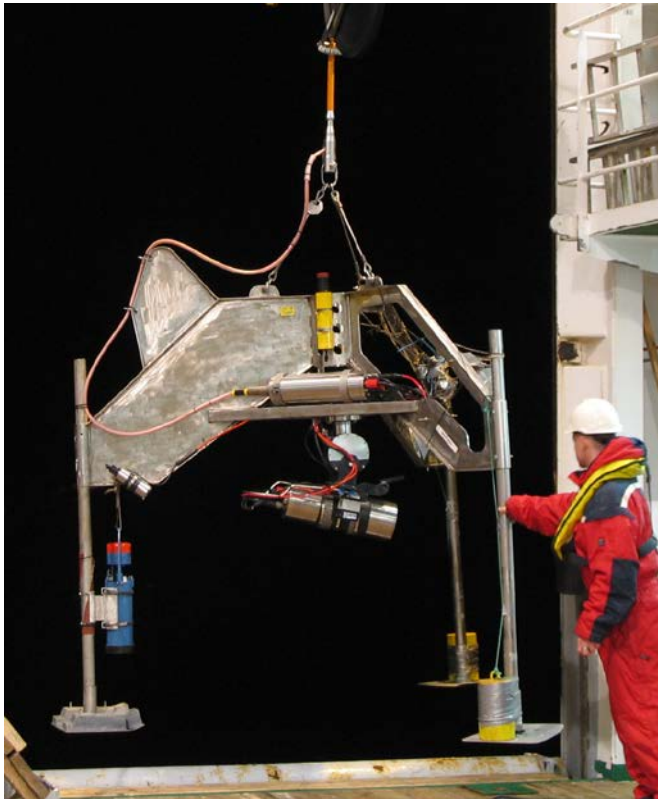
Figur 4.2. Videoriggen Campod (t.v.) med kontroll- og loggeutstyr (t.h.).
