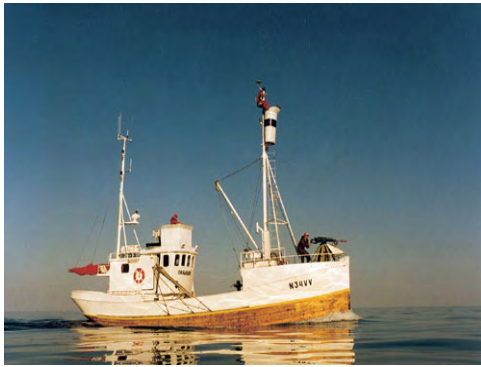
Figur A.8.8. Et tradisjonelt fartøy for fangst av vågehval. Legg merke til den svarte konsesjonsstripa på utkikkstønna og den røde granaten på harpunen i kanonen. Granaten bidrar til umiddelbar avlivning av hvalene.
