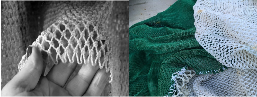
Figur 3. Maskevidde i fiskeposen (20 mm) i Campelen-trålen (til v.) og i innernettet (10 mm) (til h.). Mesh size in cod end (20 mm) of the Campelen trawl (left) and in the inner net (10 mm) (right).
