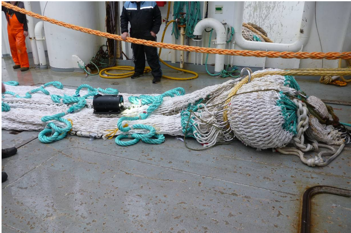
Figur 14. Undervannskamera montert framfor codline, hal 3. Dessverre ble kameraet revet av under pumping (på plass under innhiving, borte etter pumping).
