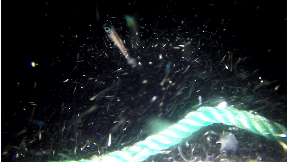
Figur 19. Hal 4 kl. 06:52:22, ca. 500 m dyp. Vassild og fiskeskjell passer ut av sekken under fiskefasen (trål stabilt på fiskedyp). Kameraet peker bakover mot codline.
